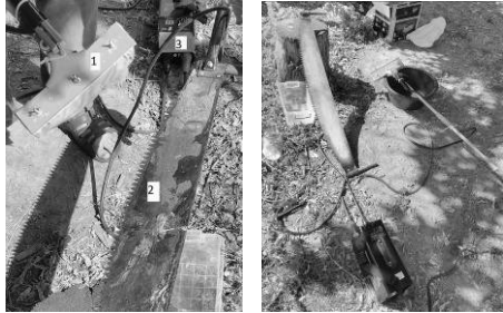
Рис. 1. Напівпромислова установка для нанесення цинкових покриттів способом електронатирання: 1 – електрод інструмент (анод), 2 – дослідний зразок катод, 3 – джерело постійного струму (зварювальний інвертор).
